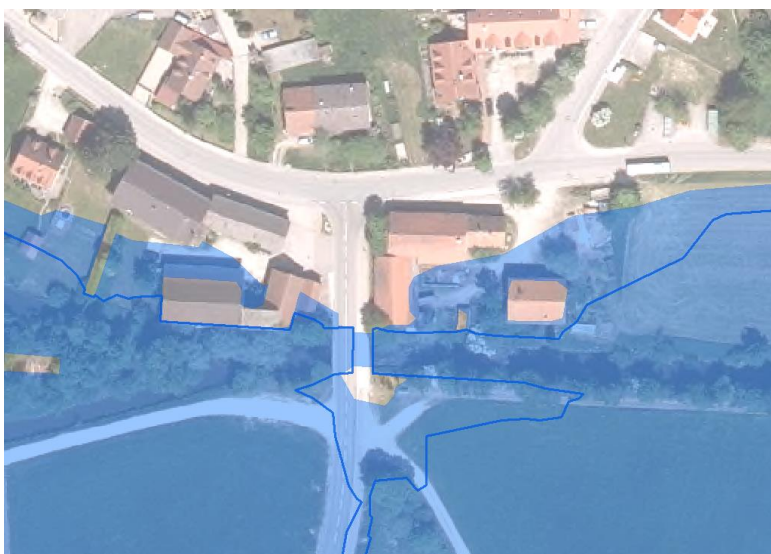
Abbildung 8 - Einstau der Gebäude bei Eisolzried
