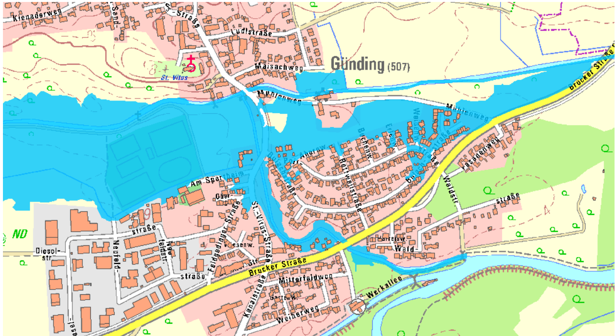
Abbildung 3: vorläufig gesichertes Überschwemmungsgebiet HW 2103 Bereich Günding (Quelle: WWA [U11])
